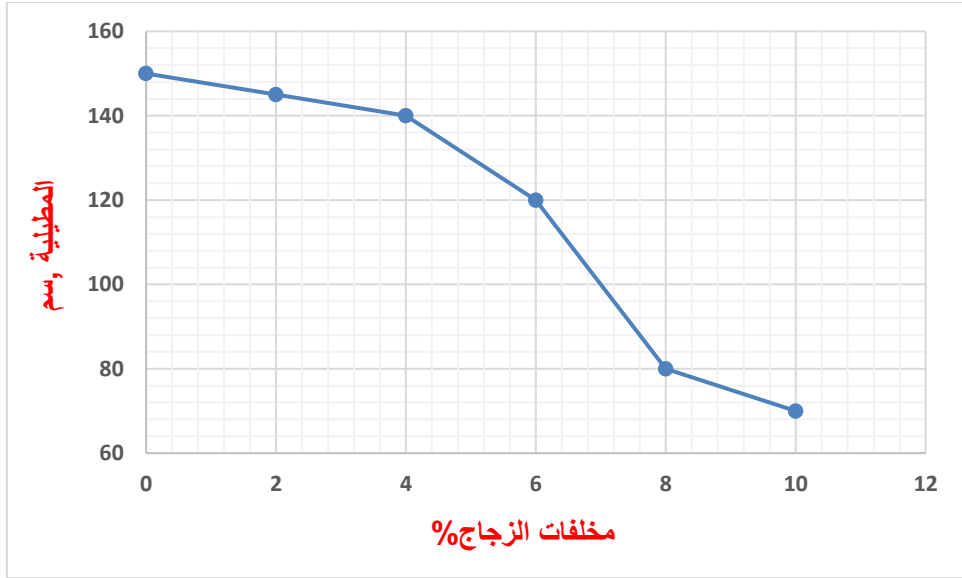
شكل (18) تأثير نسب مخلفات الزجاج على المطيلية (الاستطالة)
