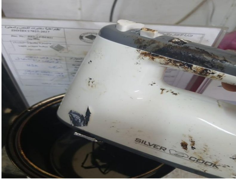
شكل (9) جهاز خلط مخلفات الزجاج مع الاسفلت
